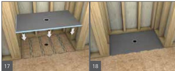
17. Installer le wedi Fundo Ligno dans un lit de colle à carrelage conformément au manuel d'installation de Ligno.
