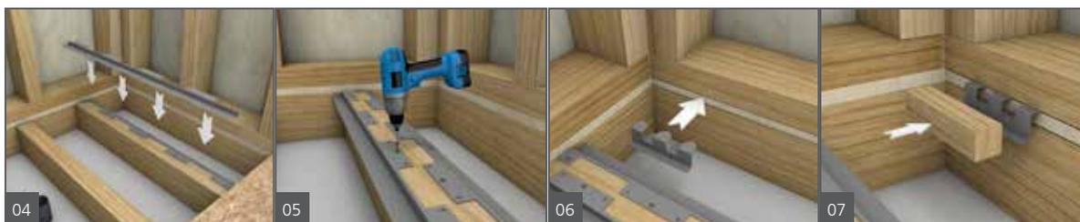
4. Fixer le support suivant de l'autre côté de la solive de plancher. Décaler les languettes de telle manière à ne pas avoir à couper les supports.
