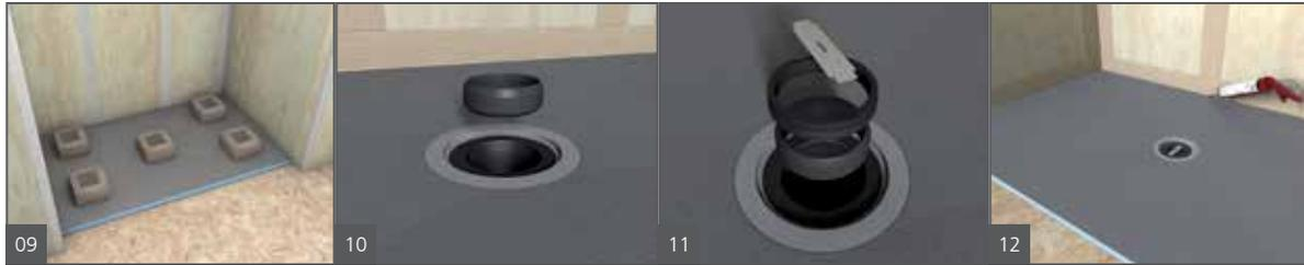
9. Enfoncer fermement le produit d'étanchéité Fundo dans le lit de ciment-colle, en vérifiant que l'installation soit de niveau et exempte de vide. Répartir et laisser des poids sur la surface, puis drainer la zone pour permettre au ciment-colle de prendre initialement sans être dérangé (par exemple, poser des sacs de ciment-colle).
